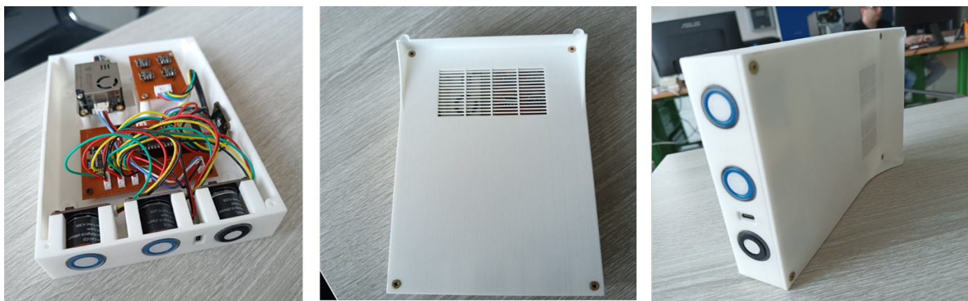
Figura 55: Case per la board 2 e 3
