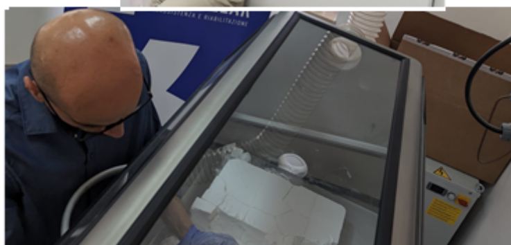
Figura 53: pulizia e rimozione polvere nylon non sinterizzata
